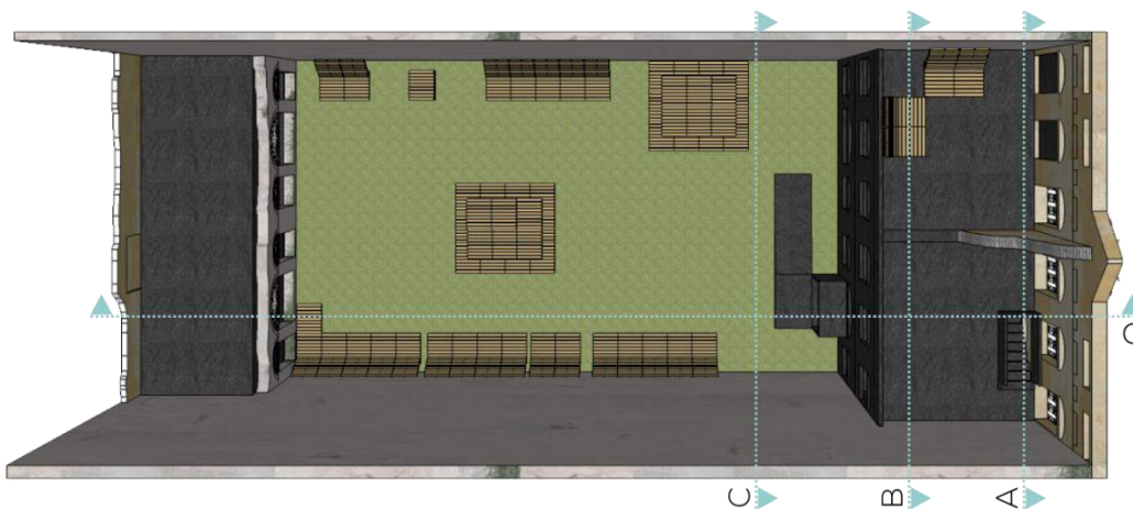
Figura 93: Planta baixa perspectivada indicando a volumetria proposta e as pré-existências.
